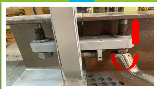
②修正側のボルトを締めこむ
