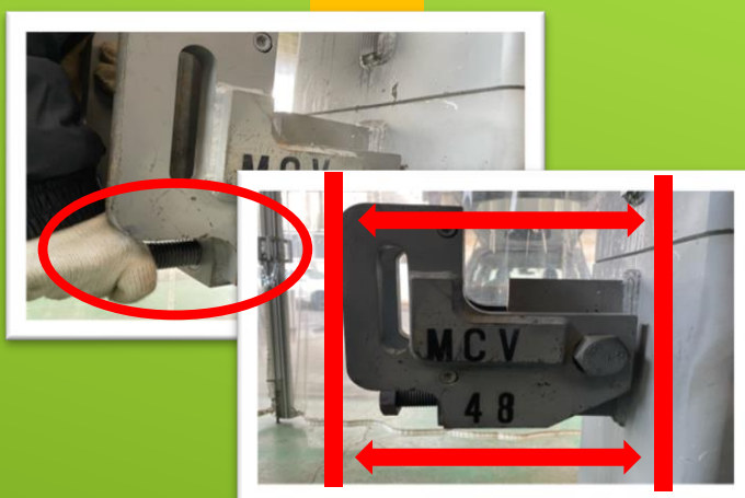
②スタビライザーの締め/緩めで 本体と柱をまっすぐにする
