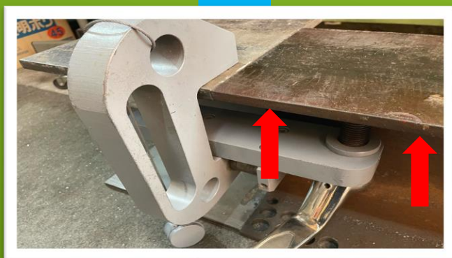
②修正側の梁が上がっていく
