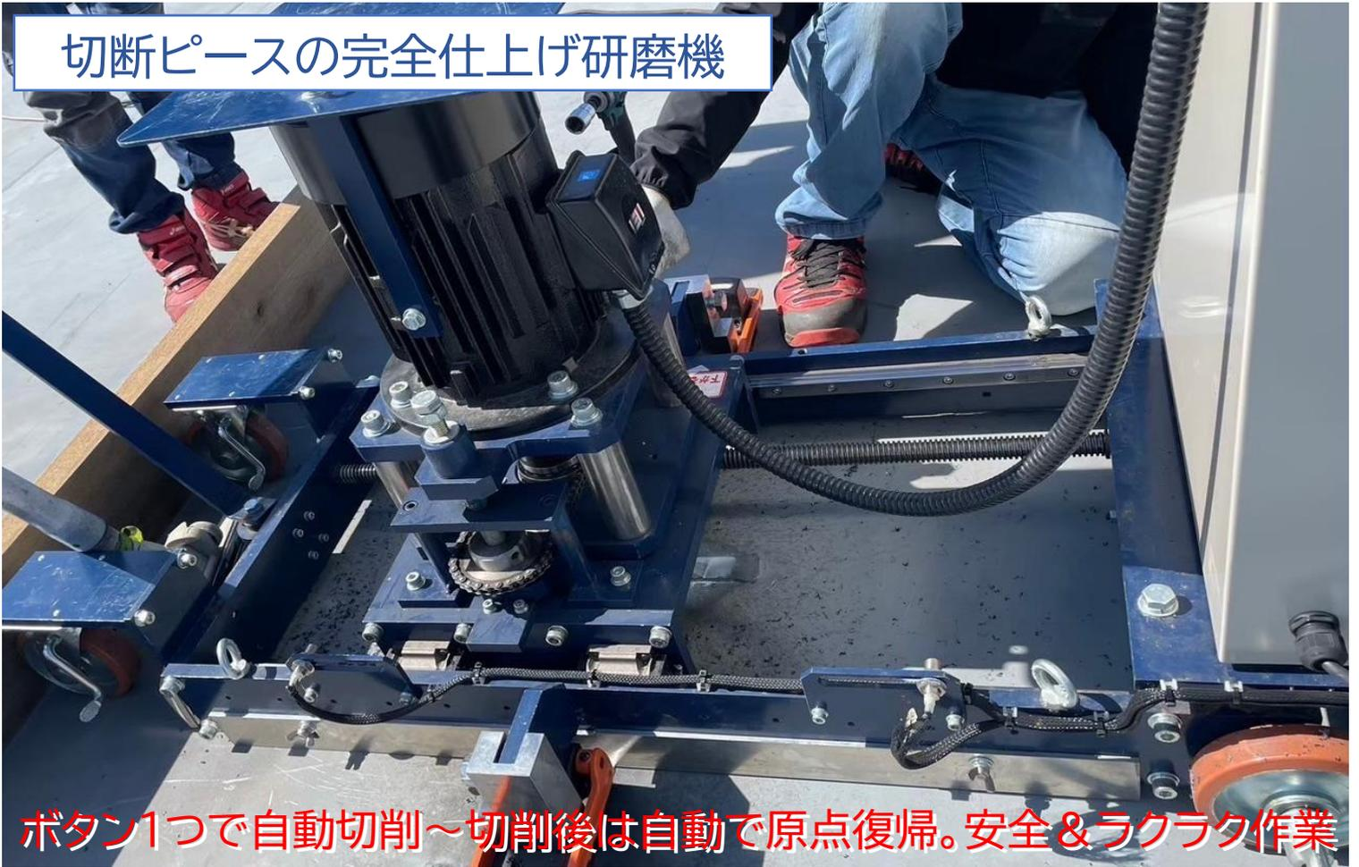
**ボタン1つで自動切削～切削後は自動で原点復帰。安全&ラクラク作業**
